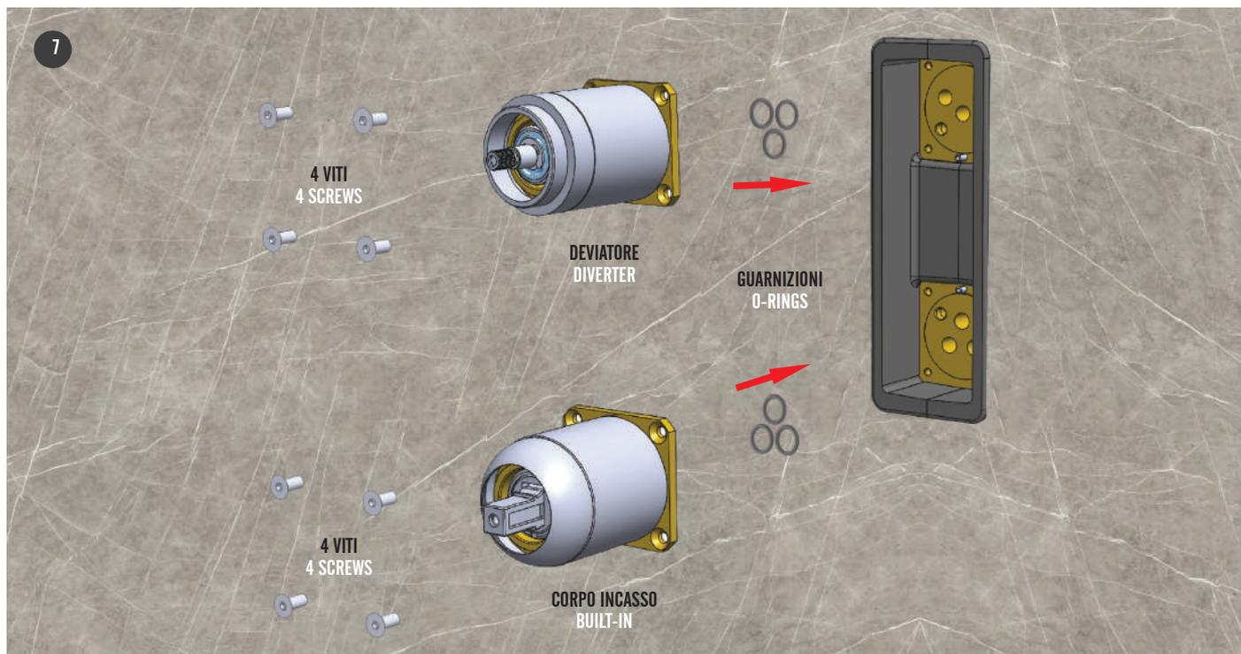
Montare i 2 incassi cromati all'interno del box aiutandosi per il corretto assemblaggio del miscelatore con la spina di centraggio in dotazione. Durante questa fase assicurarsi di aver inserito le piccole guarnizioni indispensabili per la tenuta ermetica nei passaggi acqua.
