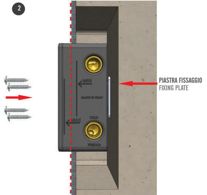
Fissare il box incasso con 4 viti al muro tramite piastra per fissaggio.
