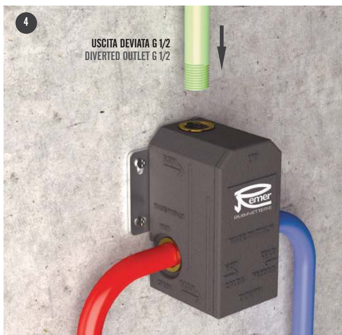
Collegare la tubazione superiore dell'uscita deviata da G 1/2 alla doccia. Connect the G1/2 outlet output upper pipe to the handshower.
