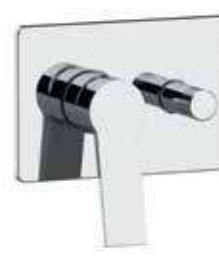
SL09HRG Miscelatore a incasso per vasca/doccia con deviatore a 2 vie con vitone ceramico, su piastra rettangolare, montaggio orizzontale. Per selezionare l'uscita desiderata, la manopola del deviatore deve essere ruotata da una posizione all'altra. Built-in bath/shower mixer with 2-way diverter with ceramic head valve, on rectangular plate, horizontal mounting. To select the desired output, the diverter knob must be turned from one position to the other.
