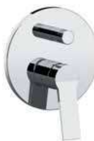
SL09H Miscelatore a incasso per vasca/doccia con deviatore a 2 vie a vitone ceramico, su piastra tonda. Per selezionare l'uscita desiderata, la manopola del deviatore deve essere ruotata da una posizione all'altra. Built-in bath/shower mixer with 2-way diverter with ceramic head valve, on round wall flange. To select the desired output, the diverter knob must be turned from one position to the other.
