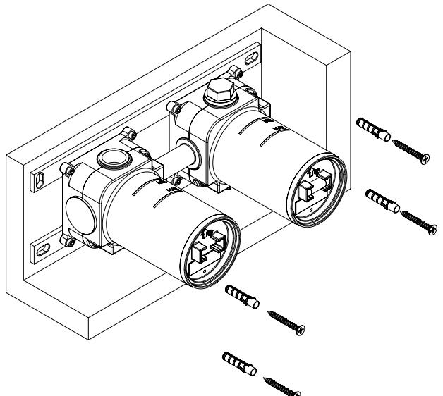
Fissare il box incasso al muro con quattro viti e tasselli da 6mm tramite piastra di ancoraggio. N.B.: la Box può essere murata oppure installata su legno o cartongesso tramite apposite viti di fissaggio.
