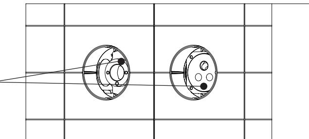
Installare le parti esterne serrando le viti al corpo incasso. Sarà necessaria una chiave a brugola di misura 2.5.
