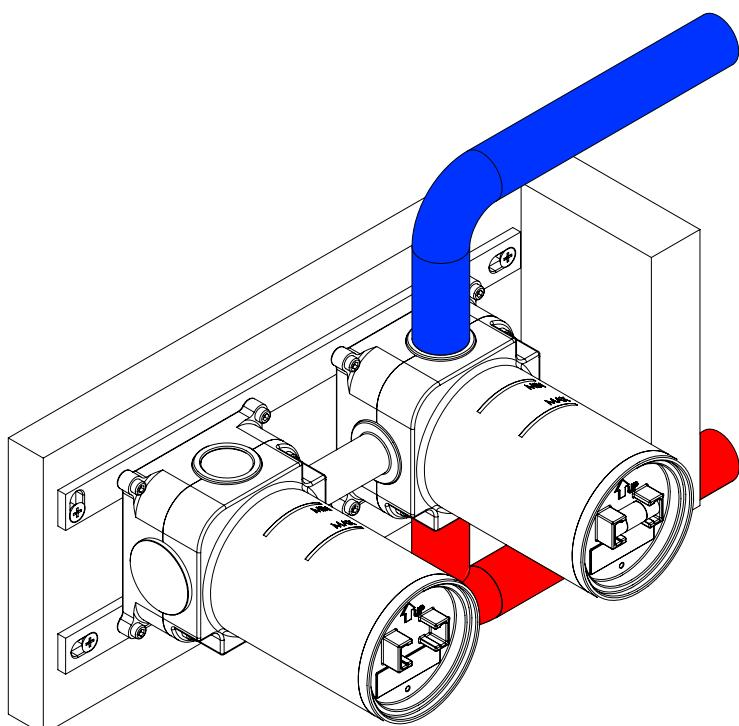
Effettuati gli allacciamenti, procedere con la prova impianto ad una pressione massima di 5bar utilizzando i tappi di prova già assemblati sull'incasso.
