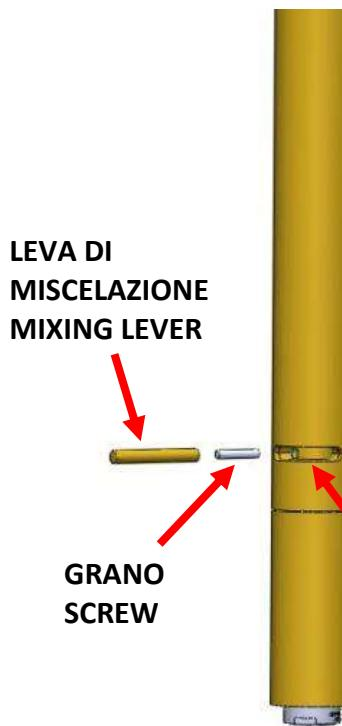
**5) AVVITARE IL GRANO NEL FORO FILETTATO DELLA CARTUCCIA E LA LEVA DI MISCELAZIONE SUL GRANO**
